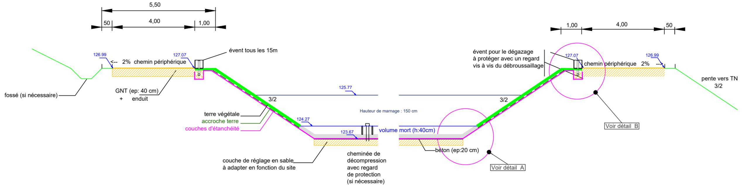
Détail A - principe d'étanchéité
