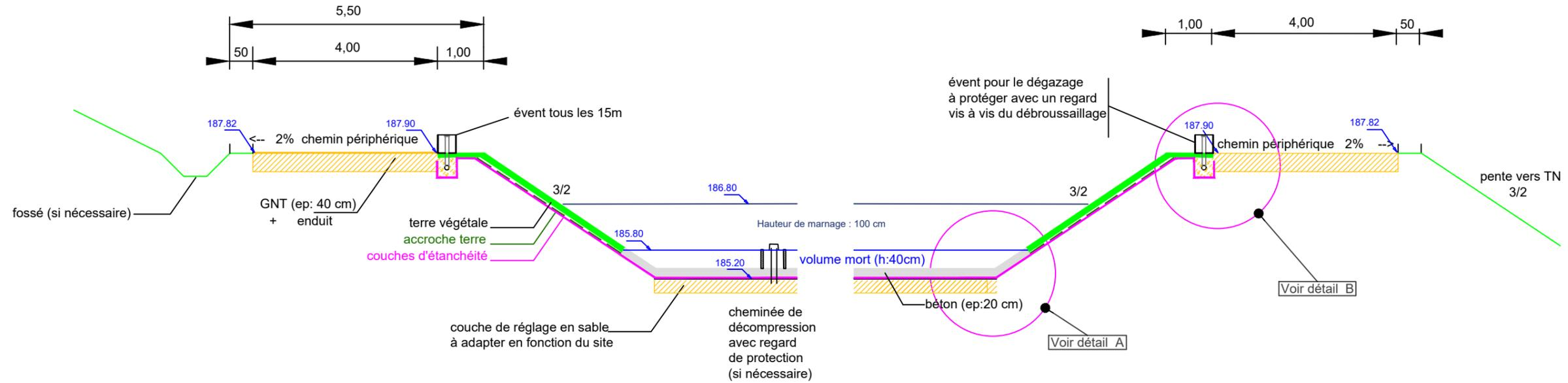
Détail A - principe d'étanchéité
