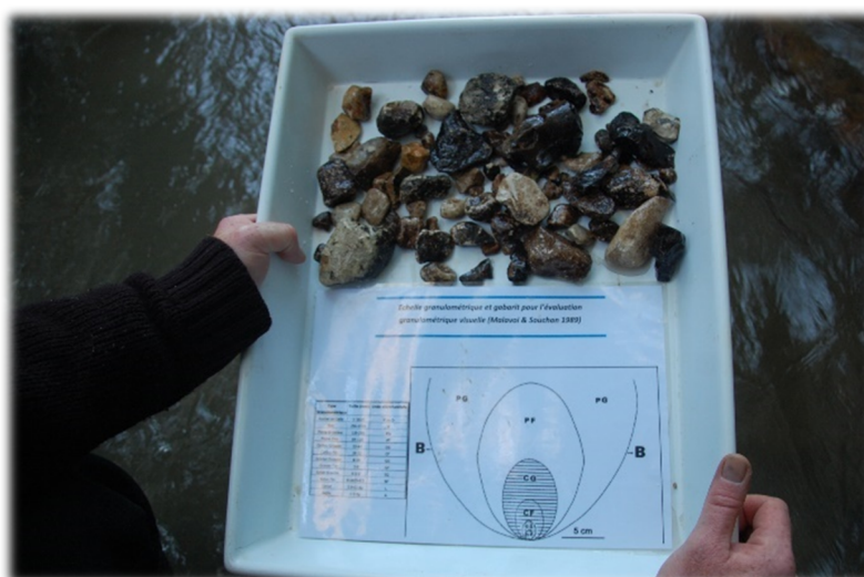
Figure 4 : Détermination de la granulométrie principale et secondaire sur une frayère (Fish-Pass)
