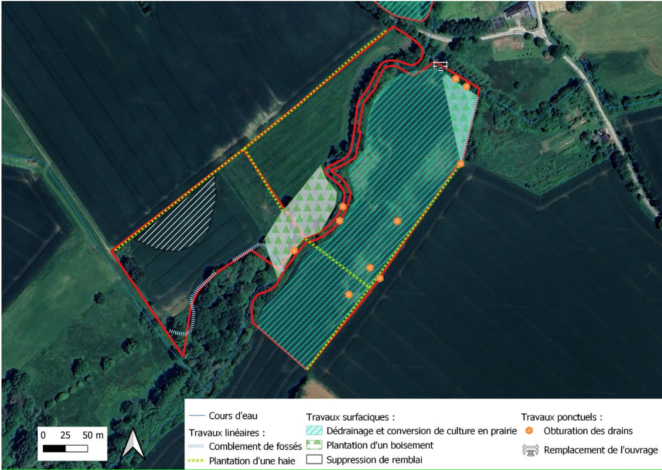
Figure 182 : Travaux envisagés sur le site de compensation – Dervenn 2025
